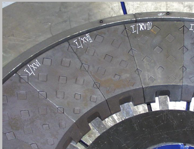
Mahlbahn für eine Schüsselmühle aus CrNi Hartguß
