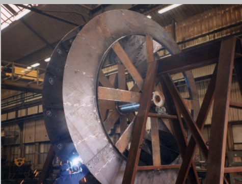
Ventilator: Laufrad aus A.S.S. -Verbundblech
