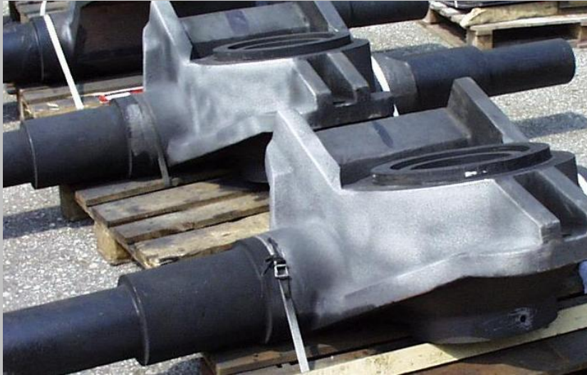
Mahlpendel einer Schüsselmühle, geschützt durch ARC-Metallspritzen
